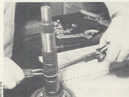
Repose des anneaux d'arrêt à l'aide d'une pince plate et de la pince à circlips
