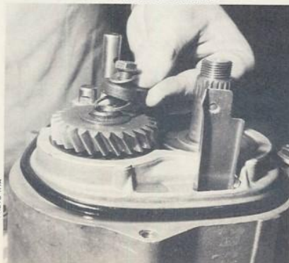
Rondelle circlip entretoise et vis de pignon de 5 e d'arbre secondaire
