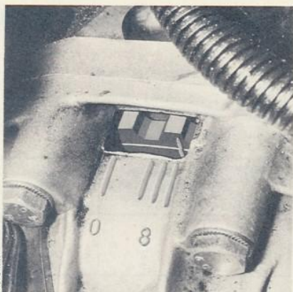
Repère mobile sur volant moteur pour A.E.I.
