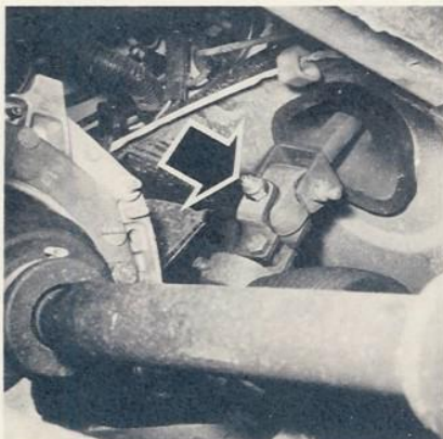
Désaccouplement du cardan de direction
