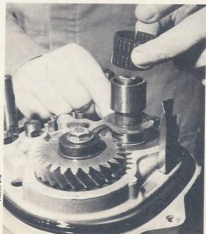
Cage aiguilles bague et rondelle du pignon de 5 e d'arbre primaire
