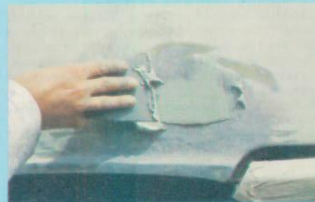
6. Appliquer le mastic polyester souple pour cacher les fibres du mastic polyester armé et pour boucher les creux et les fissures restants (séchage : 20 minutes).
