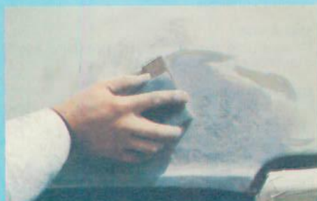
5. Ponçage plus fin au papier n° P 80.
