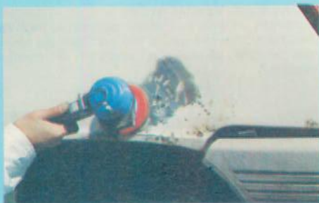
2. Poncer au disque n° P 36 pour éliminer la rouille et le reste de peinture écaillée.
