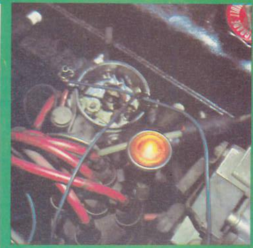
REGLAGE STATIQUE AVEC UNE LAMPE TEMOIN (CLICHE E.A.)
