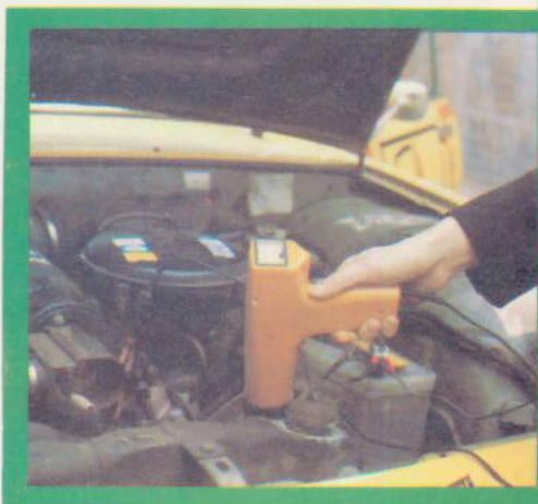
CONTROLE DU POINT D'ALLUMAGE A LA LAMPE STROBOSCOPIQUE (DOC. BOSCH)
