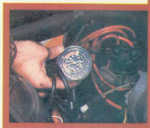
CONTROLE DE LA DEPRESSION DU MOTEUR (CLICHE E.A.).
