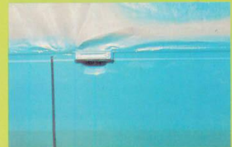
10. Passer un tampon d'essuyage avant de peindre. Pulvériser un voile de laque puis une couche simple. Laisser sécher 5 minutes et terminer par une couche croisée.
