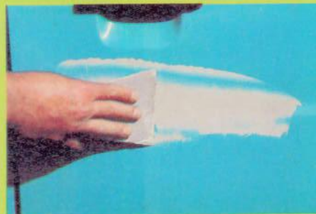
3. Couvrir de mastic polyester souple la zone poncée (séchage : 20 minutes).
