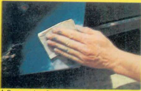
4. Poncer plus finement les bords de la zone mastiquée au papier n° P 120.
