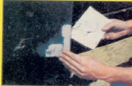
2. Couvrir de mastic polyester souple la zone poncée à l'aide d'une cale ou d'une spatule (séchage : 20 minutes).
