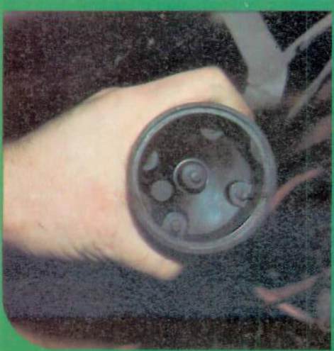
CONTROLLER SUR LE CHAPEAU, SI CELUI-CI N'EST PAS FELE, SI LE CHARBON CENTRAL N'EST PAS USE ET VERIFIER LES PLOTS DE CONTACT (CLICHE E.A.)
