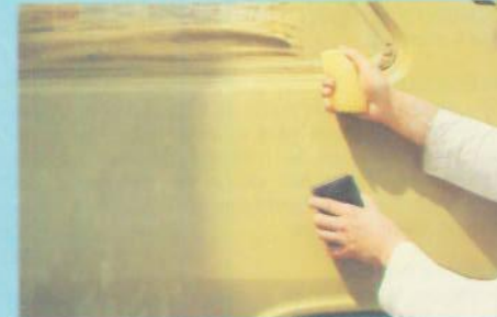
10. Poncer à l'eau au papier n° P 800. Rincer à l'eau claire et sécher.
