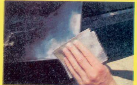
3. Dégrossir le ponçage au papier n° P 60.
