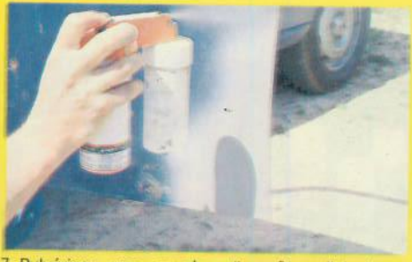
7. Pulvériser une couche d'apprêt cellulosique garnissant suffisamment mouillée pour faire disparaître les dernières imperfections. Laisser sécher 5 minutes avant d'appliquer la deuxième couche (séchage : 1 heure).
