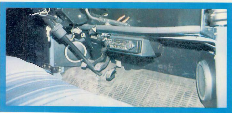
INSTALLATION DEFINITIVE D'UN AUTORADIO, LECTEUR DE CASSETTES STEREO (CLICHE E.A.)
