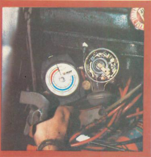
CONTROLE DES COMPRESSIONS DU MOTEUR (CLICHE E.A.).
