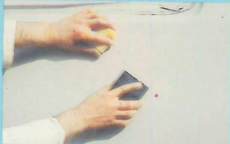
14. Poncer à l'eau au papier n° P 800/P 1.000. Rincer et sécher.
