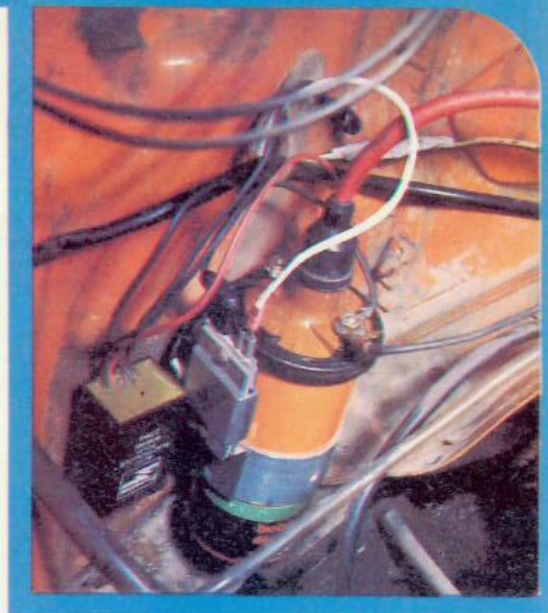
MONTAGE DEFINITIF DE LA NOUVELLE BOBINE (CLICHE E.A.)
