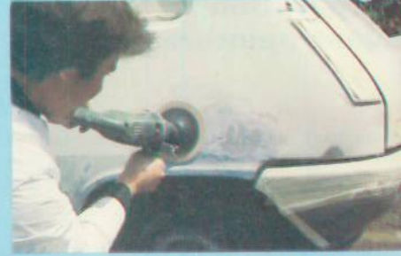
4. Dégrossir le ponçage au disque n° P 60.
