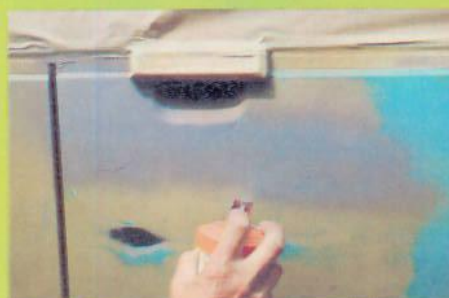
8. Pulvériser une couche d'apprêt cellulosique suffisamment mouillée. Attendre quelques minutes avant d'appliquer la deuxième couche. (séchage : 1 heure).
