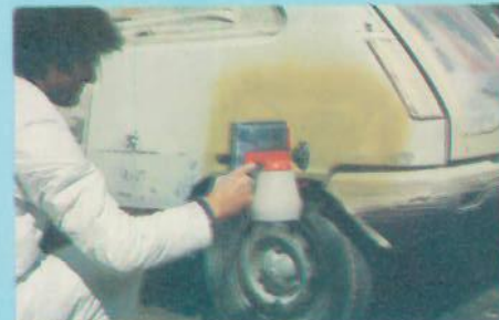
9. Protéger les surfaces voisines. Appliquer une couche mince de primaire garnissant en voile. Puis pulvériser 2 couches en ménageant un temps d'évaporation entre chaque couche (séchage : 1 heure).
