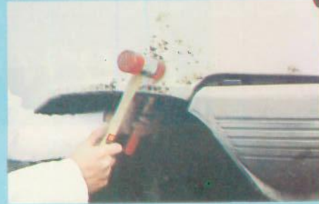
1. Redresser la tôle à l'aide d'un maillet.
